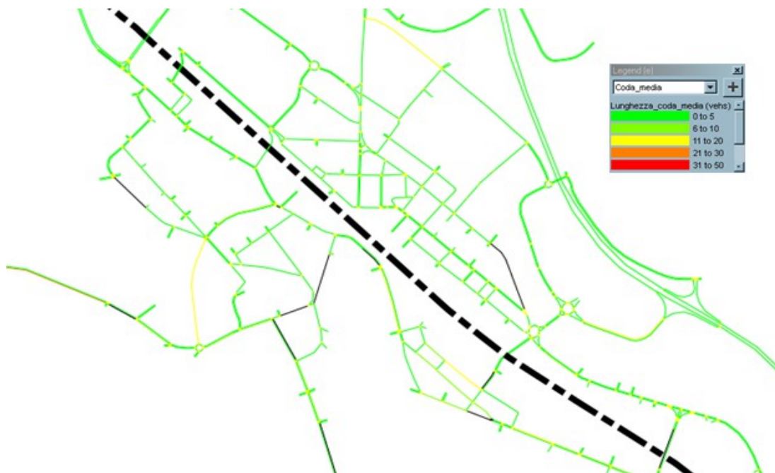
Figura 17: Lunghezza della coda media (numero di veicoli) per l'ora di punta pomeridiana – scenario di progetto
